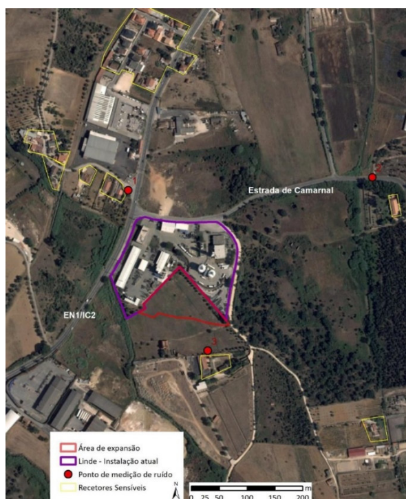
Identificação das fontes sonoras, recetores sensíveis mais próximos e localização do ponto de medição de ruído na envolvente da Linde (Fonte: EIA, 2022).
